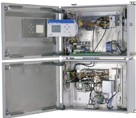
Innenansicht mit 2 NDIR-Bänken in einem unbeheizten oberen Gehäuseteil, optional eine „beheizte Box“ im unteren Teil, E/A-Platinen.
