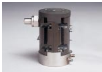
Miniaturisierter Flammenionisationsdetektor (Mikro FID)
